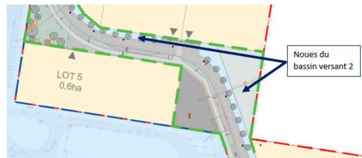
Figure 20 : Localisation des ouvrages d'infiltration – BV2 – Source : OGI
